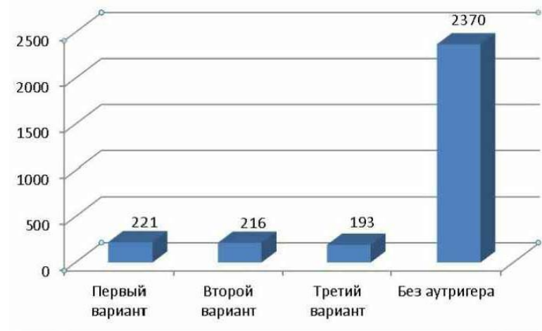
Рис. 20. Сравнение значений перемещений от воздействия статической составляющей ветровой нагрузки вдоль оси ОУ
