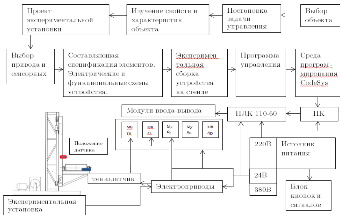
Рис. 5. Структурная схема экспериментального устройства на базе электромеханического стенда и контроллера ОВЕН ПЛК 110-60
