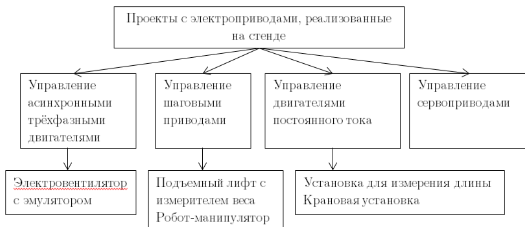
Рис. 3. Классификация задач по типам управления двигателями
