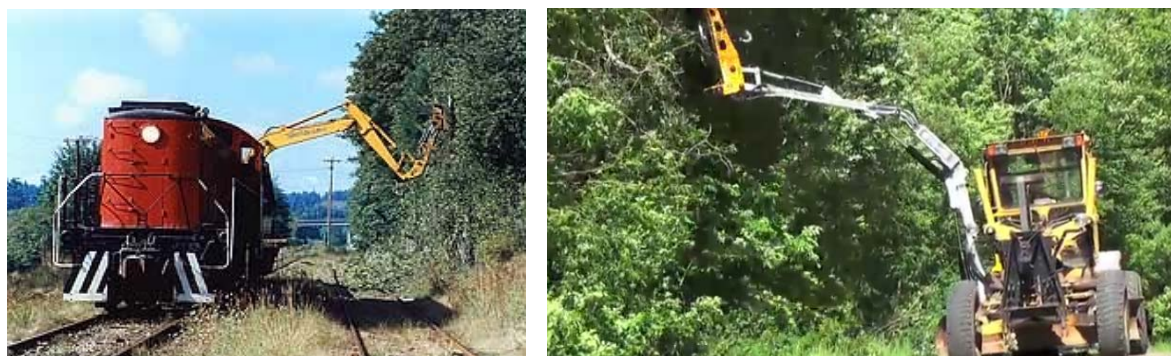
Рис. 1. Удаление нежелательной поросли машинами с манипуляторной установкой
