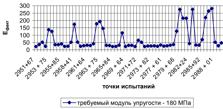
Рис. 2 Прочность дорожной одежды автомобильной дороги Хабаровск-Комсомольск на Амуре (286-299 км) 15.05.2001 г.
