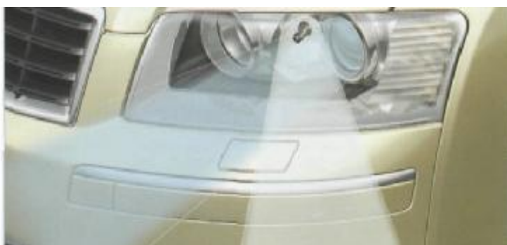
Рис. 4. Внешний вид автоматической блок-фары. когда руль машины повернут в сторону.
