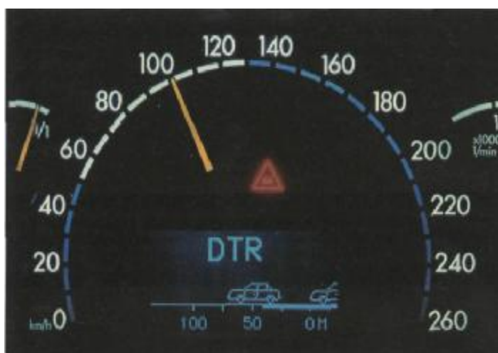
Рис.3. Внешний вид спидометра со встроенным ультразвуковым датчиком
