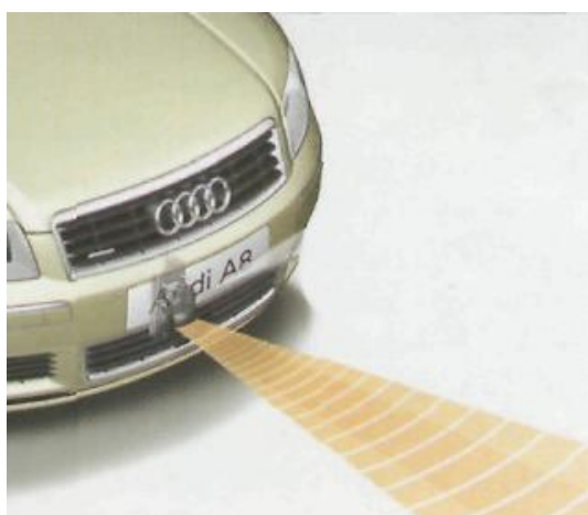
Рис.2. Ультразвуковой датчик, установленный в переднем бампере
