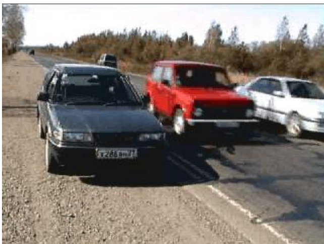
Рис. 6. Полоса движения 4.75 м. Траектория автомобиля «Нива» неизменна, возможен обгон в пределах этой полосы.
