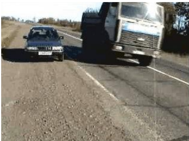
Рис. 4. Наезд на полосу встречного движения грузовым автомобилем, при полосе движения 3.5 м.
