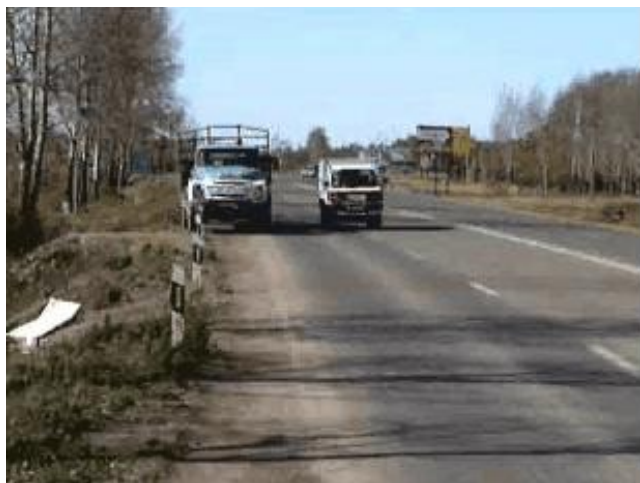
Рис. 7. Остановка грузового автомобиля на обочине шириной 1.75, заезд на проезжую часть 0.3 м.
