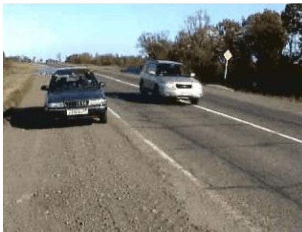
Рис. 5. Наезд на полосу встречного движения легковым автомобилем, при полосе движения 3.5 м.
