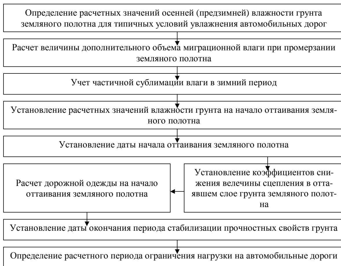
Рисунок 1. Блок-схема последовательности расчета ограничения автомобильной нагрузки в весеннее время
