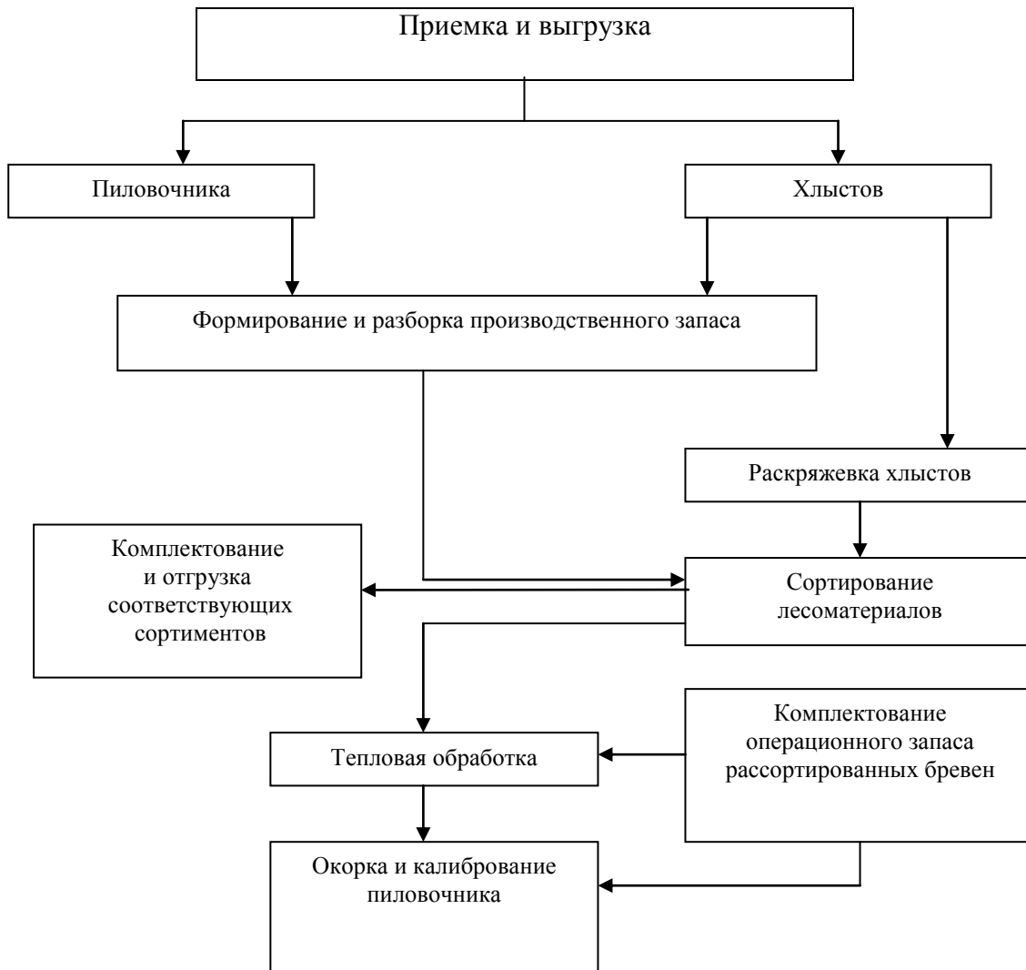
Рисунок 3 – Структурная схема технологических операций подготовки сырья к распиловке
