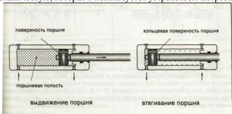
Рис.13. Гидроцилиндр двухстороннего действия
