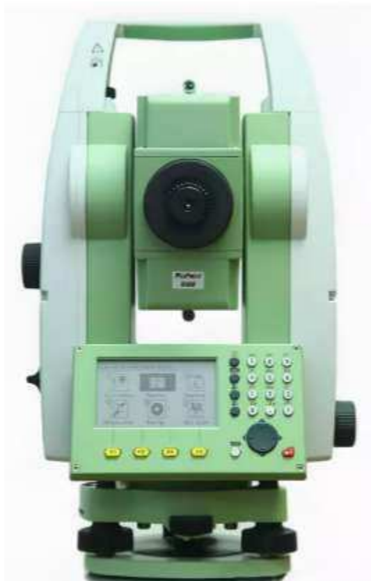
Рисунок 1 – Общий вид электронного тахеометра TS02
